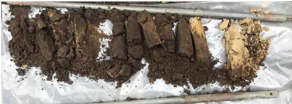
Foto van de boorkernen van boring 6 (tot 100 cm -mv)
