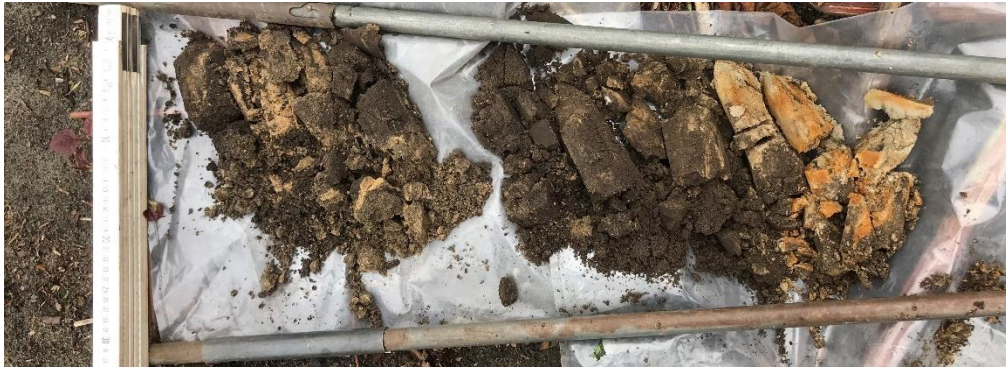
Foto van de boorkernen van boring 5 (tot 100 cm -mv)
