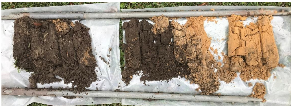
Foto van de boorkernen van boring 2 (tot 130 cm -mv)
