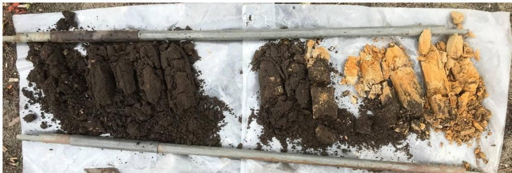
Foto van de boorkernen van boring 3 (tot 150 cm -mv)
