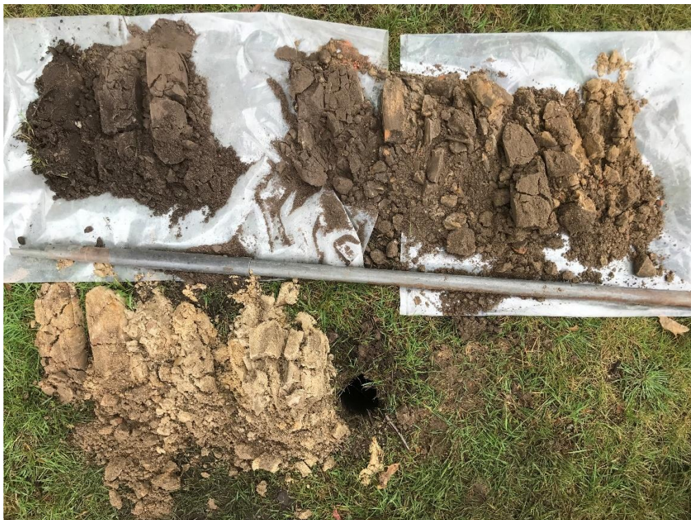
Foto van de boorkernen van boring 1 (tot 150 cm -mv)
