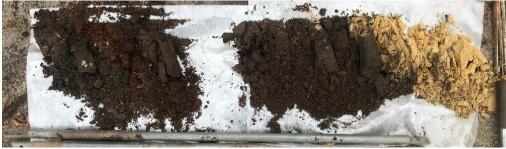
Foto van de boorkernen van boring 4 (tot 100 cm -mv)
