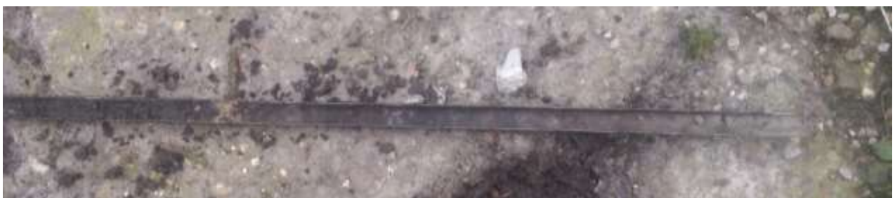
Figuur 19: Foto van boring 18 met links de geroerde toplaag en rechts het rechts het sterk lemige, ongeoxideerde zand.
