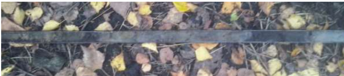
Figuur 18: Foto van boring 6 met rechts de veenlaag die hierin boven het sterk lemige zand is aangetroffen.
