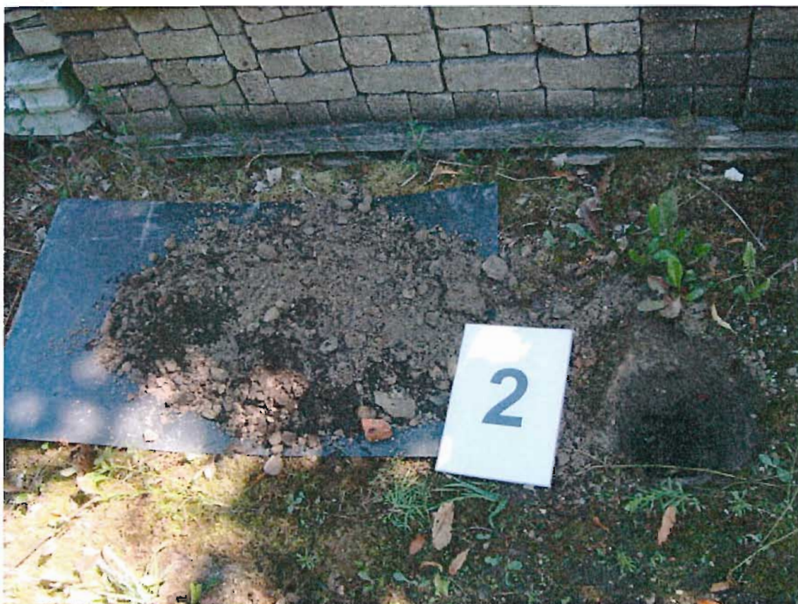
Foto 13: inspectiegat 2 met uitkomend materiaal (1 augustus 2013)
