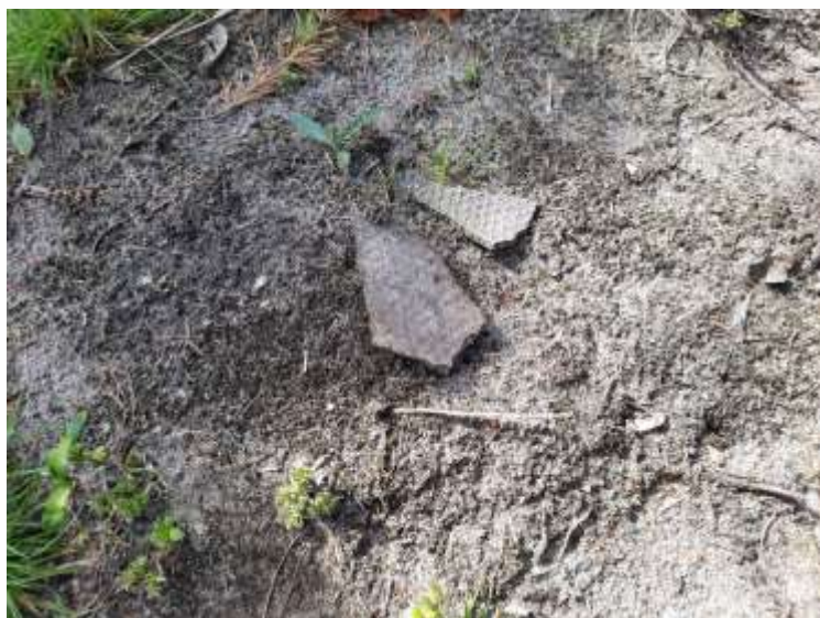
Afbeelding 6: aangetroffen asbestverdacht plaatmateriaal op het maaiveld
