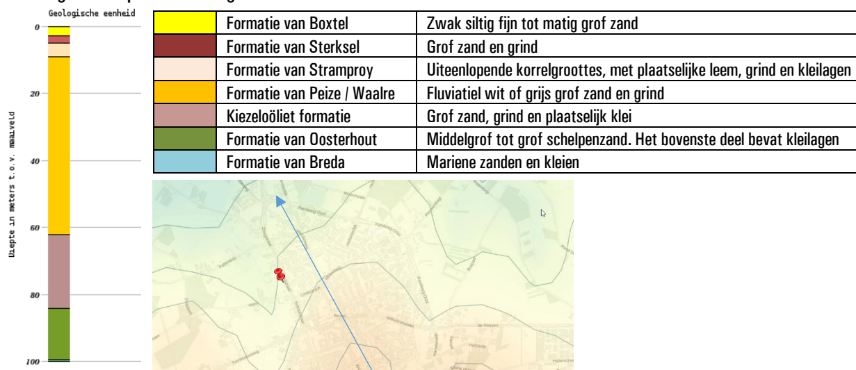
Figuur A: opbouw ondergrond.
