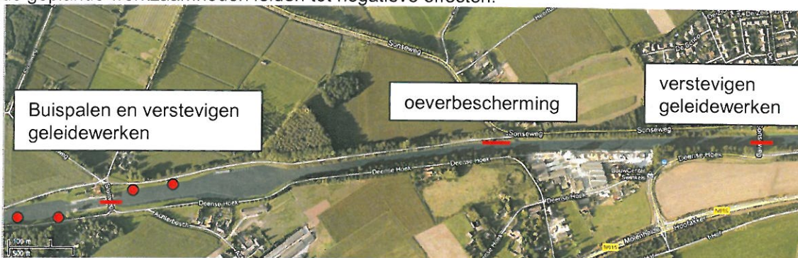
Figuur 3.5 Overzicht van de geplande werkzaamheden op de locaties Brug Deensche Hoek, Bochtversteving 4: boven Sluis V zuidzijde en Sluis V.
