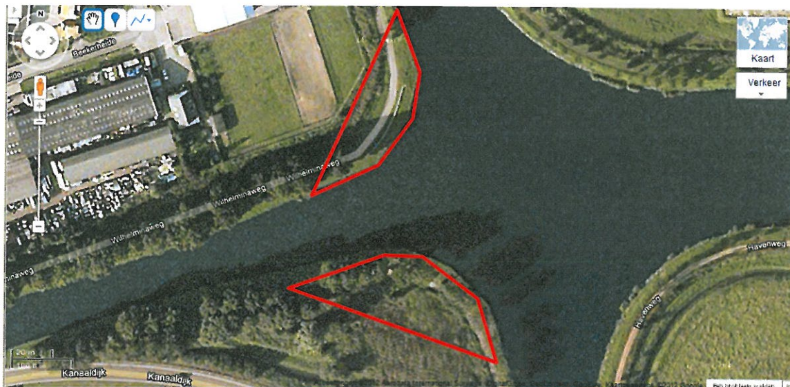
Figuur 6.3 Locatie 9. Bomen op de te ontgraven gronden ten behoeve van bochtverruiming (binnen rode polygonen) dienen te worden geveld.
