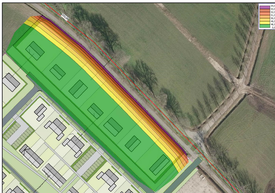
Figuur 4-1 Toetsingswaarde ( L_{den} ) in dB, door verkeer op de Pater Becanusstraat, inclusief corr. art. 3.4 RMG 2012 (gridhoogte 4,5 meter)
