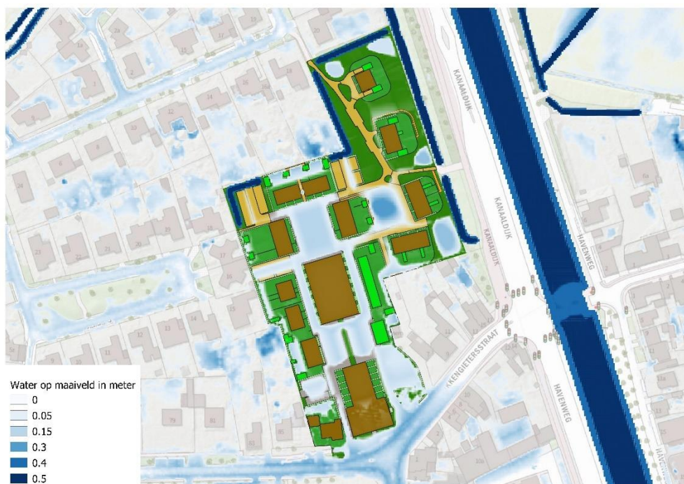
Figuur 13: Maximaal waterniveau op maaiveld
