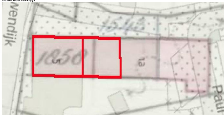
Afb. 65 Zelfde plattegrond. Hierop is aangegeven hoe de contour van het café en woonhuisvolume zich verhoudt tot de plattegrond uit 1904: er is geen duidelijke relatie. De scheidende muur tussen beide volumes correspondeert niet en de muur tussen het woonvolume en nummer 1 is niet bepaald vanuit een historische situatie.
