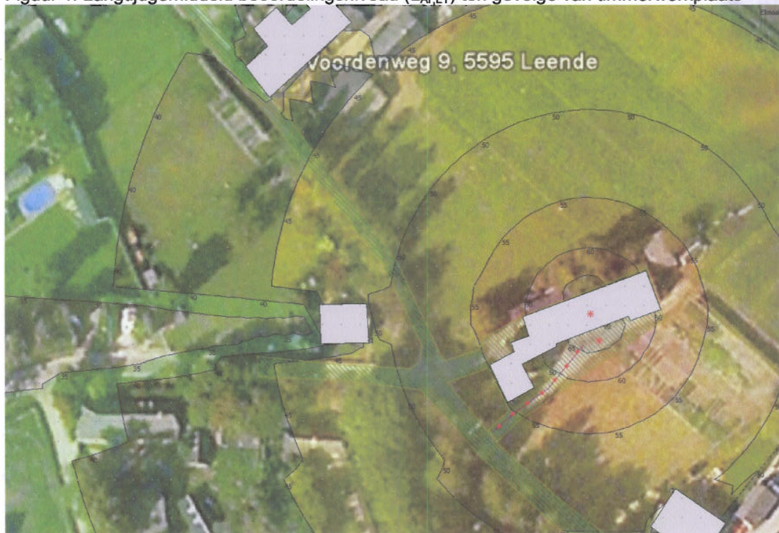
Figuur 1: Langtijdgemiddeld beoordelingsniveau ( L_{A,r,LT} ) ten gevolge van timmerwerkplaats
