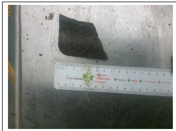
Foto 4. Asbestverdacht materiaal A01-4
