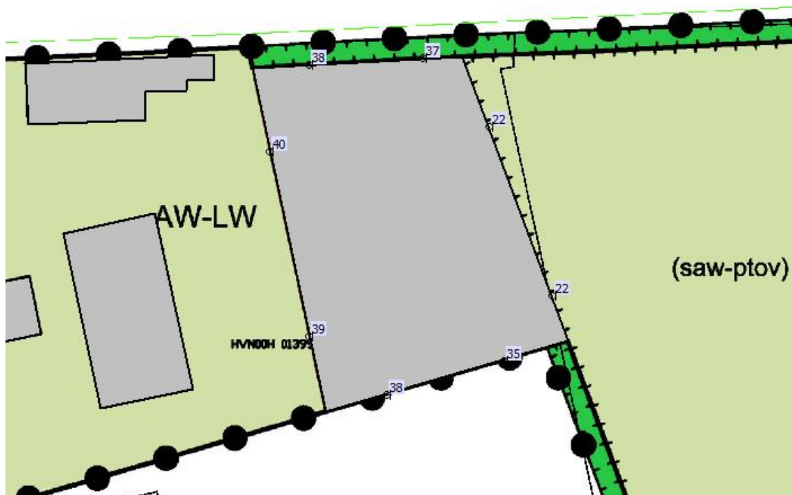
Figuur 4.3: Geluidbelastingen a.g.v. wegverkeer Roosendaalseweg/Parallel-weg/Nijverheidsweg
