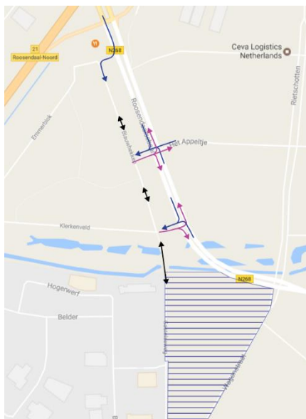
Figuur 3.1: Alternatieve ontsluiting bedrijventerrein plan Delin, Borchwerf II via Klerkenveld.
