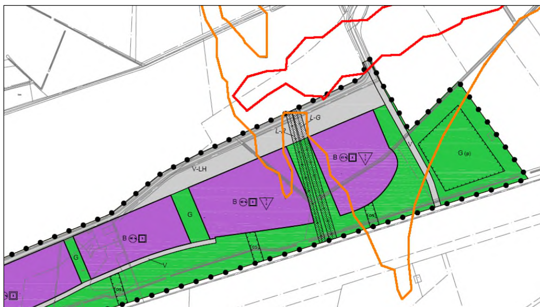
Figuur 3.1: PR-contouren (rood: 10^{-5} en oranje: 10^{-6} ) luchthaven ('Externe veiligheidsrisico door vliegverkeer rond Luchthaven Seppe' – NLR, 2011)
