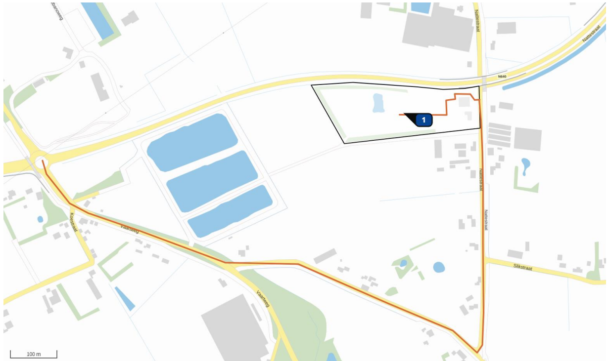
Figuur 3.2 gemodelleerde bronnen realisatiefase (de vlakbron is voor mobiele werktuigen en de lijnbronnen zijn voor het bijbehorende verkeer). Bron: AERIUS, 2022.
