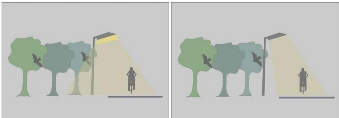
Figuur 9.1: Voorbeeld gerichte verlichting. Links: ongerichte verlichting. Rechts: gerichte verlichting waarbij lichtverstoring wordt voorkomen. (Bron: Zoogdiervereniging, 2013)
