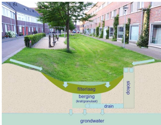
Figuur 4-3 Voorbeeld van de werking van een wadi (bron: website www.klimaatadaptatienederland.nl van Kennisportaal Klimaatadaptatie, 2020)
