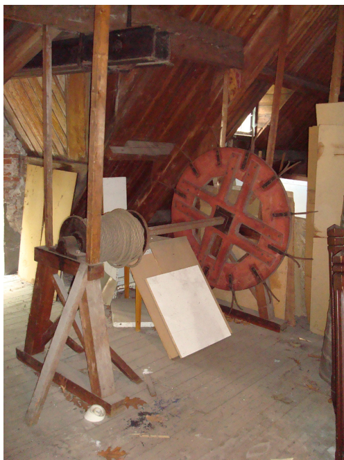
Afb. 193 Links: hijssrad op de zolder van de zuidvleugel. Afb. 194 Rechts: hijssrad uit de zeventiende- of achttiende eeuw in het woonhuis Herengracht 502 in Amsterdam.
