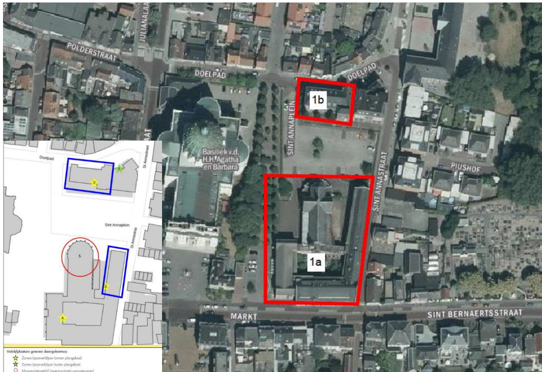
Figuur 1. Locatie Sint Annagebouw (1a) en muziekschool (1b). De activiteiten vinden plaats binnen de rood omlijnde gebieden aangegeven op de luchtfoto. In blauw aangegeven de delen die gesloopt worden. De rode cirkel geeft de kapel aan, waar geen werkzaamheden zullen worden uitgevoerd.
