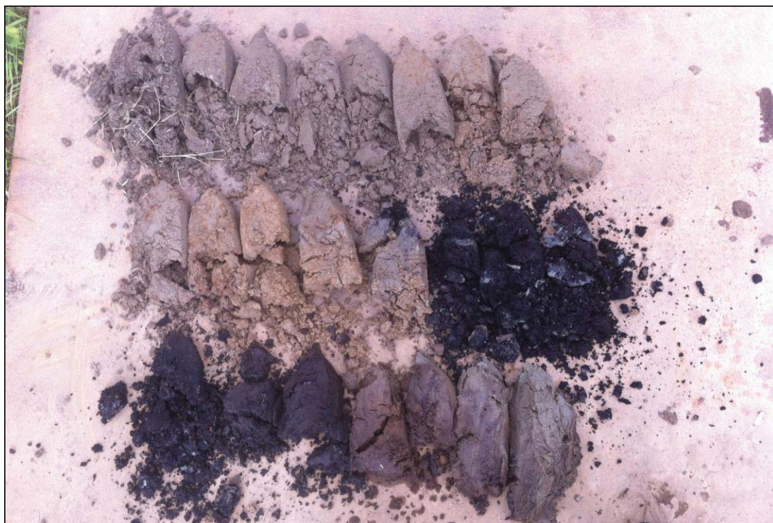
Figuur 5: boorprofiel van boring 4
