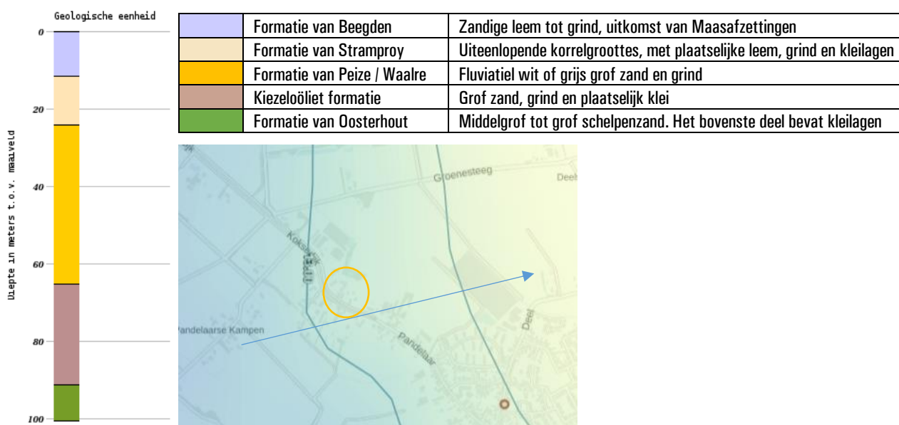
Figuur A: opbouw ondergrond.
