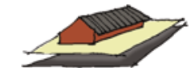
Voorbeeld: Goede standaardverhouding tussen dak en gevel van 2:1 door dakverlenging (overstek)
