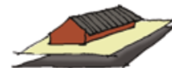
Voorbeeld: Goede standaardverhouding tussen dak en gevel van 2:1 door dakverlenging (overstek)
