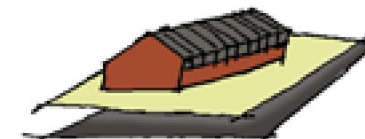
Voorbeeld: Goede standaardverhouding tussen dak en gevel van 2:1, door dakverlenging over de gevel
