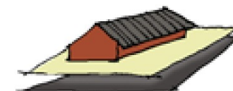
Voorbeeld: Goede standaardverhouding tussen dak en gevel van 2:1 door dakverlenging (overstek)
