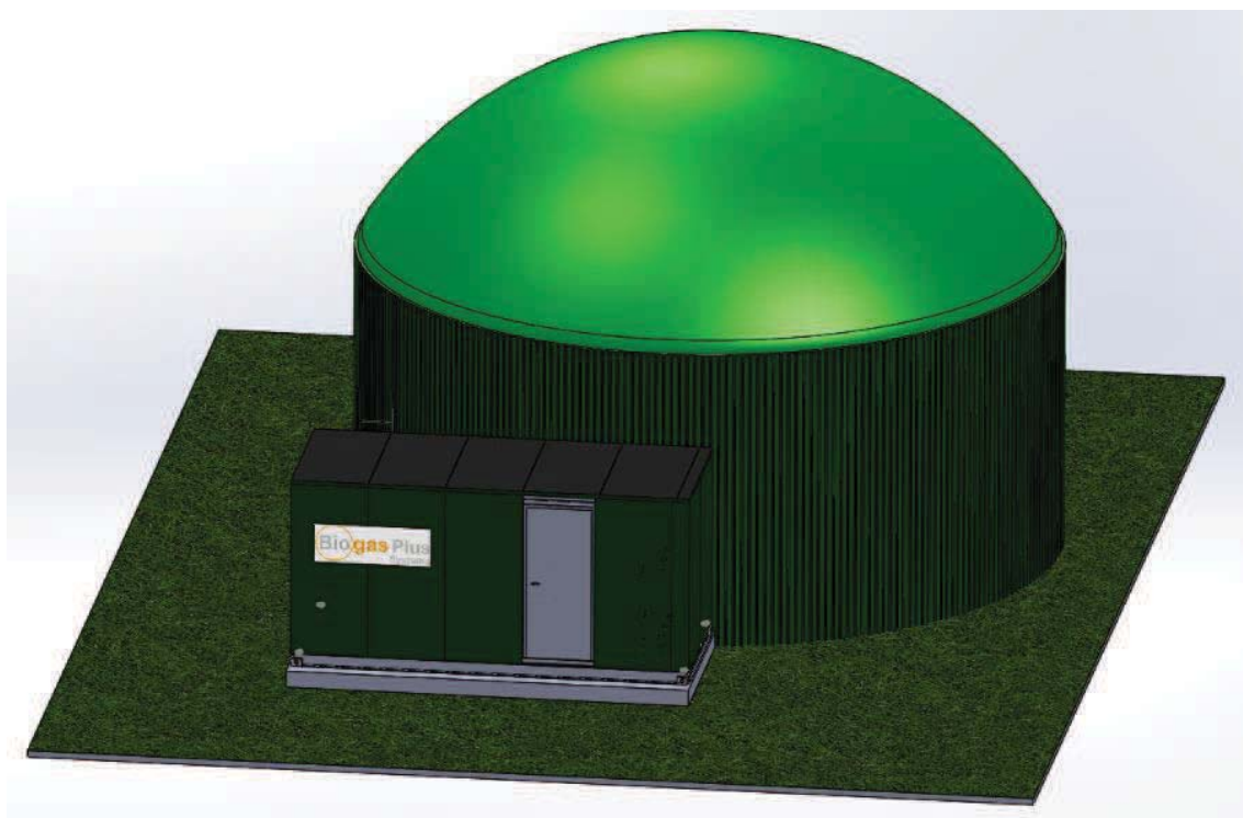
Figuur 1: 3D tekening Compact Plus Mestvergister
