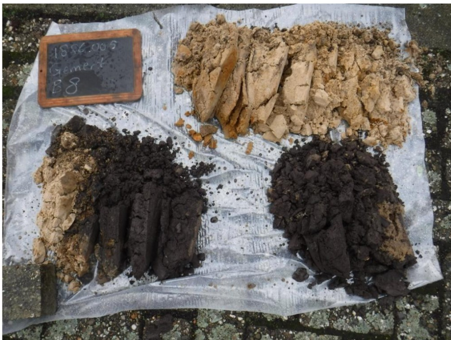
Boring 8; dik pakket recent geroerd materiaal (top van het bodemprofiel ligt rechtsonder), direct op de C-horizont
