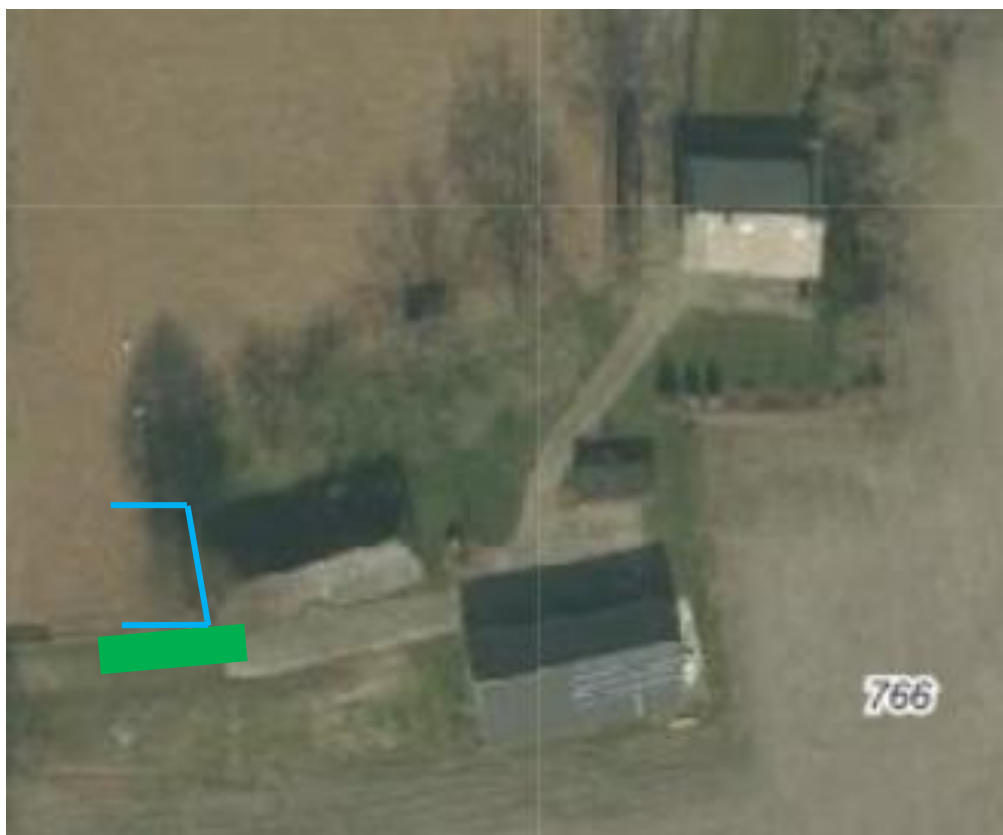
Afbeelding 11, Voorbeeld van de plaatsing van boombeschermingsmaatregelen waarbij blauwe lijn bouwhekken zijn en het groene vlak de druk verdelende rijplaten bij de inrit zijn.
