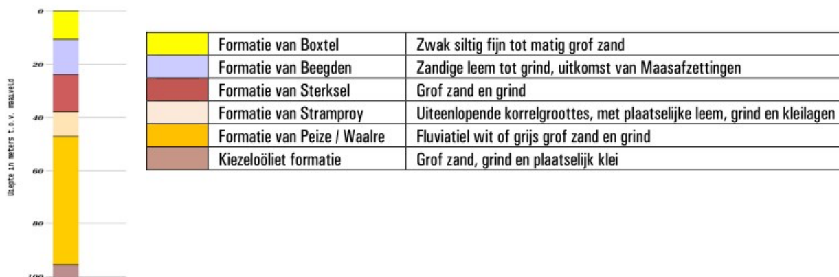
Figuur A: opbouw ondergrond.
