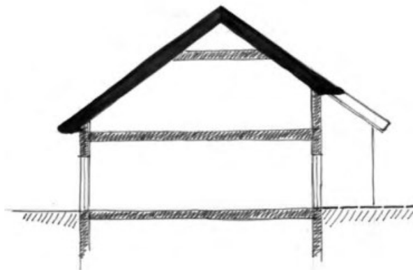
^ verschillende hoogte gootlijn voor- en achtergevel
