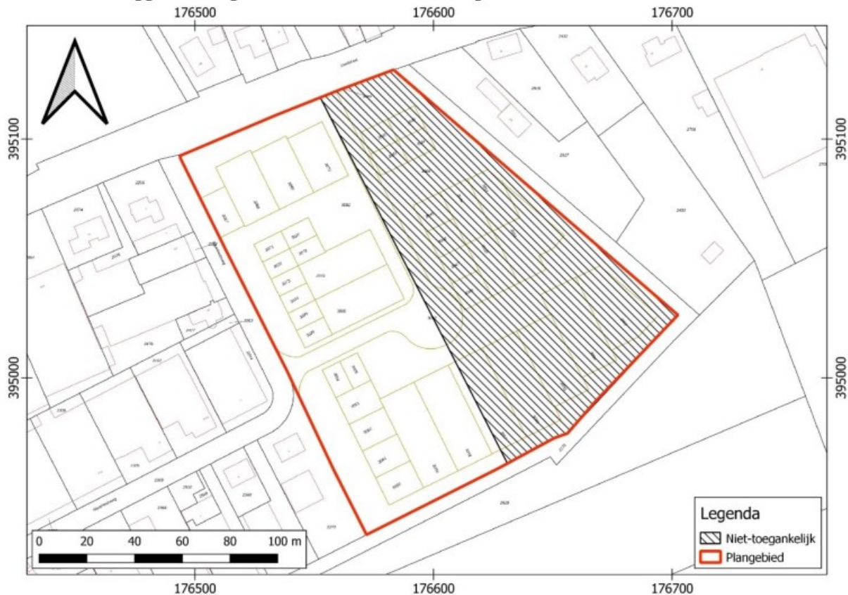
Afbeelding 10. Gearceerd de zone die bij het verkennend booronderzoek vanwege een nog uit te voeren asbestsanering niet toegankelijk voor onderzoek was. Deze zone dient nog gesaneerd te worden.
