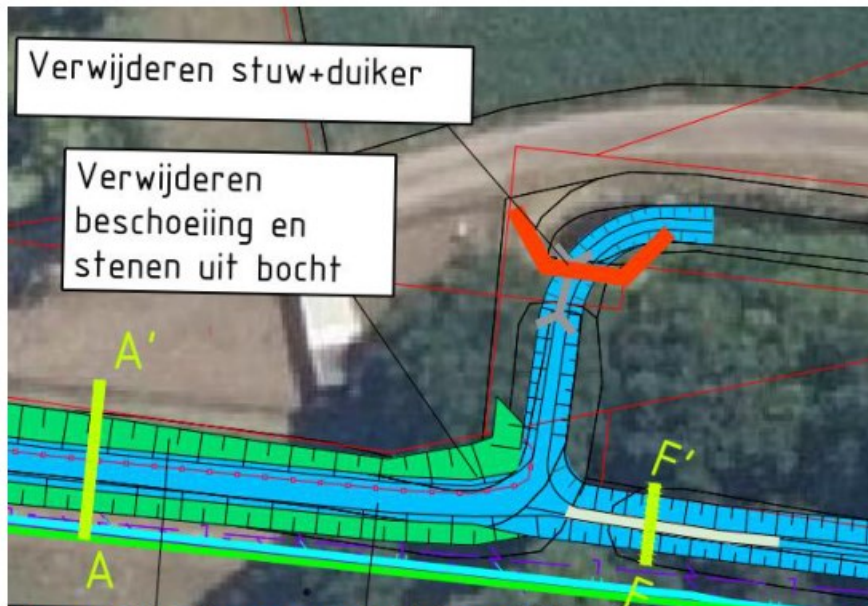
Figuur 19: Verwijderen stuw 253P, duiker en klinkers in bocht
