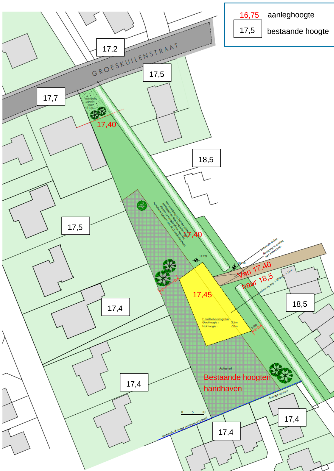
Figuur 3.5 Bestaande en aanleghoogtes Groeskuilenstraat Gemert
