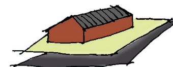
Ongewenste verhouding tussen dak en gevel (meer gevel dan dakvlak)
