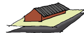
Goede standaardverhouding van 2:1 tussen dak en gevel door dakverlenging (overstek)
