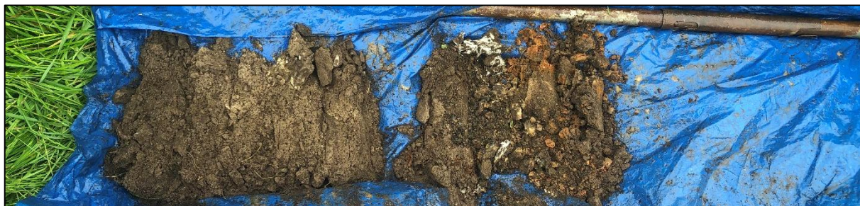
Boring 3, eerste poging. Gestaakt op 80 cm -Mv in roodbruin baksteen. Zichtbare plastic fragmenten op circa 70 cm -Mv.
