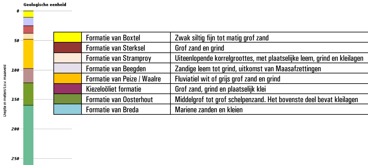
Figuur A: opbouw ondergrond.
