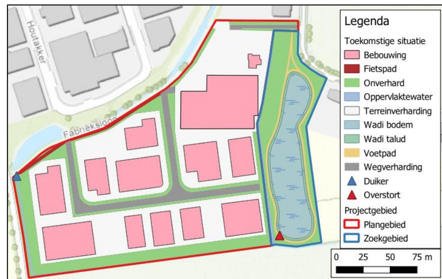
Figuur 4-1: Inrichting plangebied met waterbergende voorzieningen
