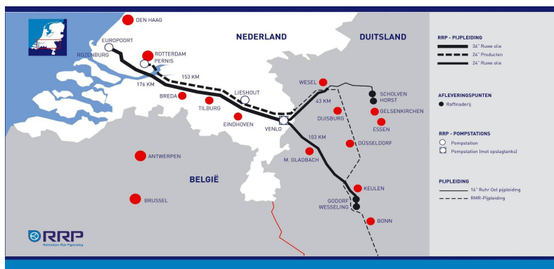
Figuur: Tracé Rotterdam-Rijn Pijpleidingmaatschappij buisleidingen
