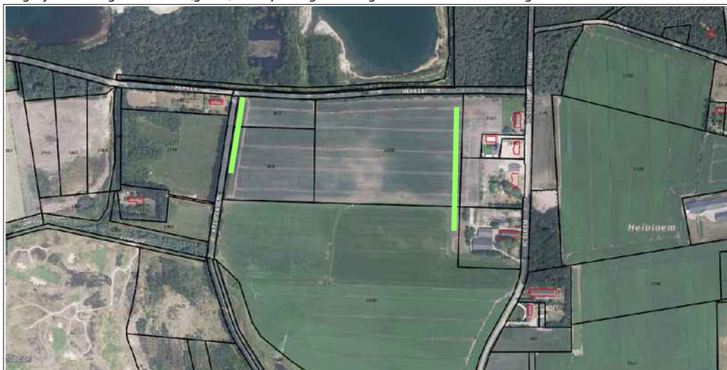
f9 Mogelijke locatie geluidwallen (groen) ter beperking van het geluid van de zandwinning.
