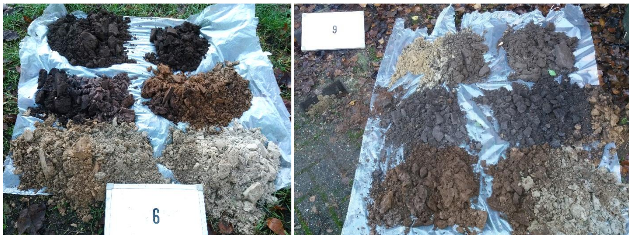
Afbeelding 4: foto boorprofiel boring 6 en 9; leesrichting van linksboven naar rechtsonder
