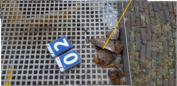
Asbestverdacht golfplaatfragment Proefgat 03
