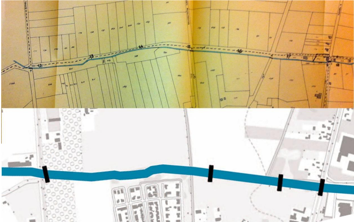
Figuur 4.3. Vergelijking historisch lengteprofiel (leggerkaart 1948) met het huidige profiel ter hoogte van traject II.
