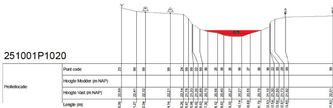
Figuur 4.6. Nieuwe doorsnede van de aangevulde loop, ongeveer halverwege traject IX. Bij gemiddelde afvoeren staat de bedding hier droog op wat grondwater na dat in de beek opkwelt.
