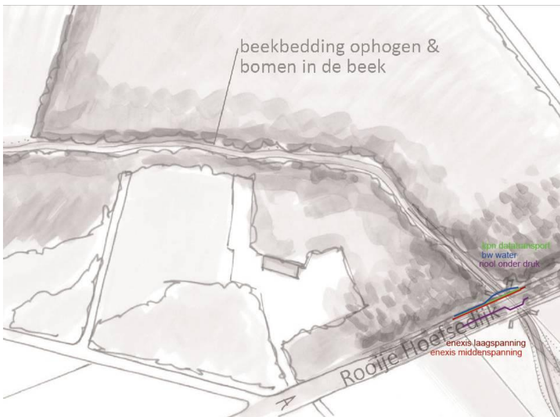
Figuur 3.28. Kabels en leidingen in traject VII
