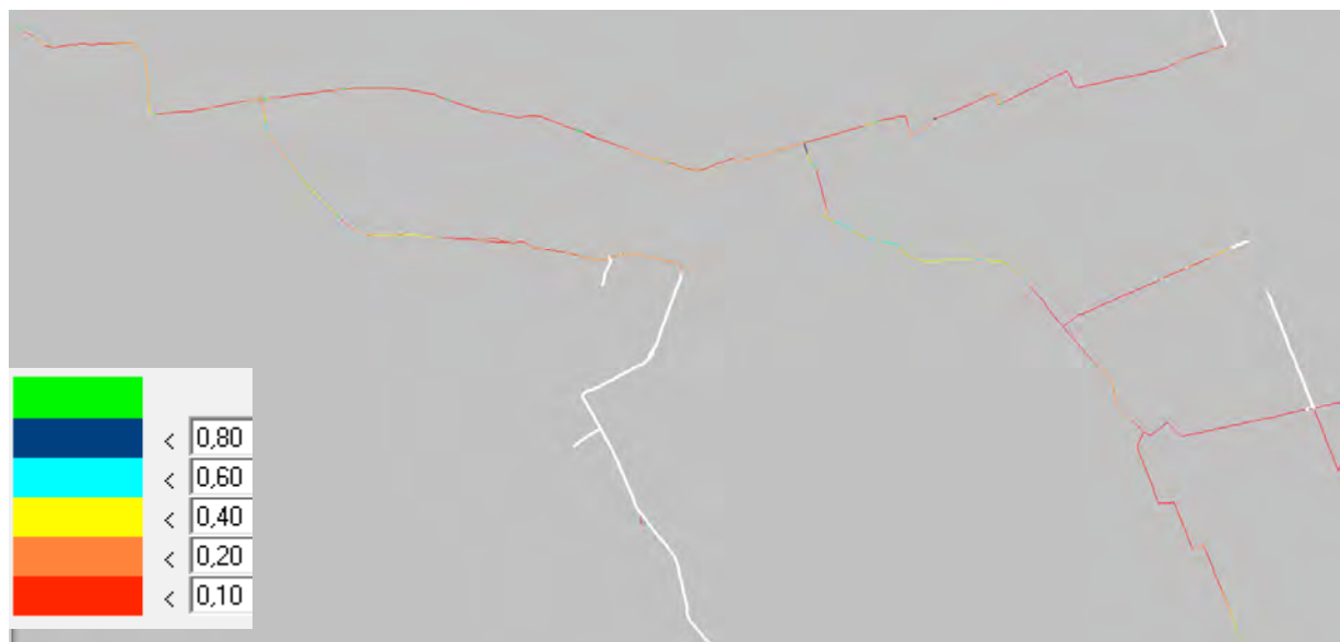
Figuur C.4: Vergelijking waterstand [m + NAP] bij gemiddelde winterafvoer (rood: huidig, blauw: nieuw)
