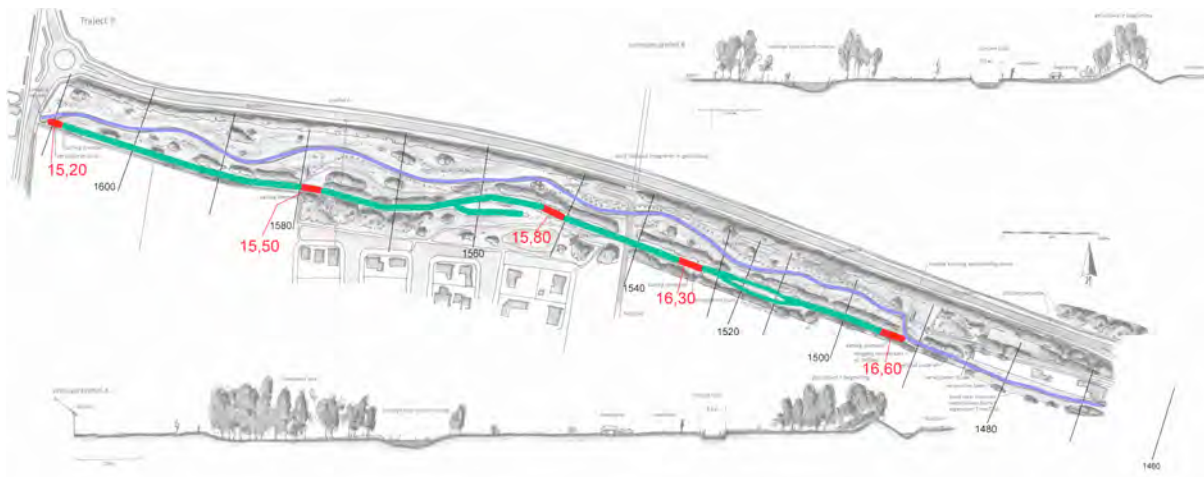
Figuur 4.22. In rood de locaties van de drempels met hoogtes in de oude bedding (groenblauw). Ernaast ligt de nieuwe vrij afstromende bedding (blauw).
