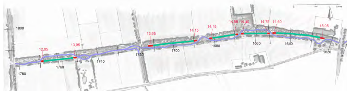
Figuur 4.26. In rood de locaties van de drempels met hoogtes in de oude bedding (groenblauw). Ernaast slingert de nieuwe vrij afstromende bedding (blauw).
