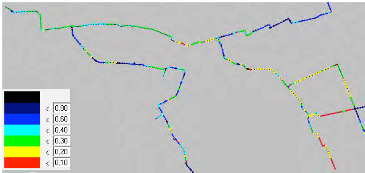
Figuur C.2: Waterdiepte [m] in de nieuwe situatie bij lage zomerafvoeren
