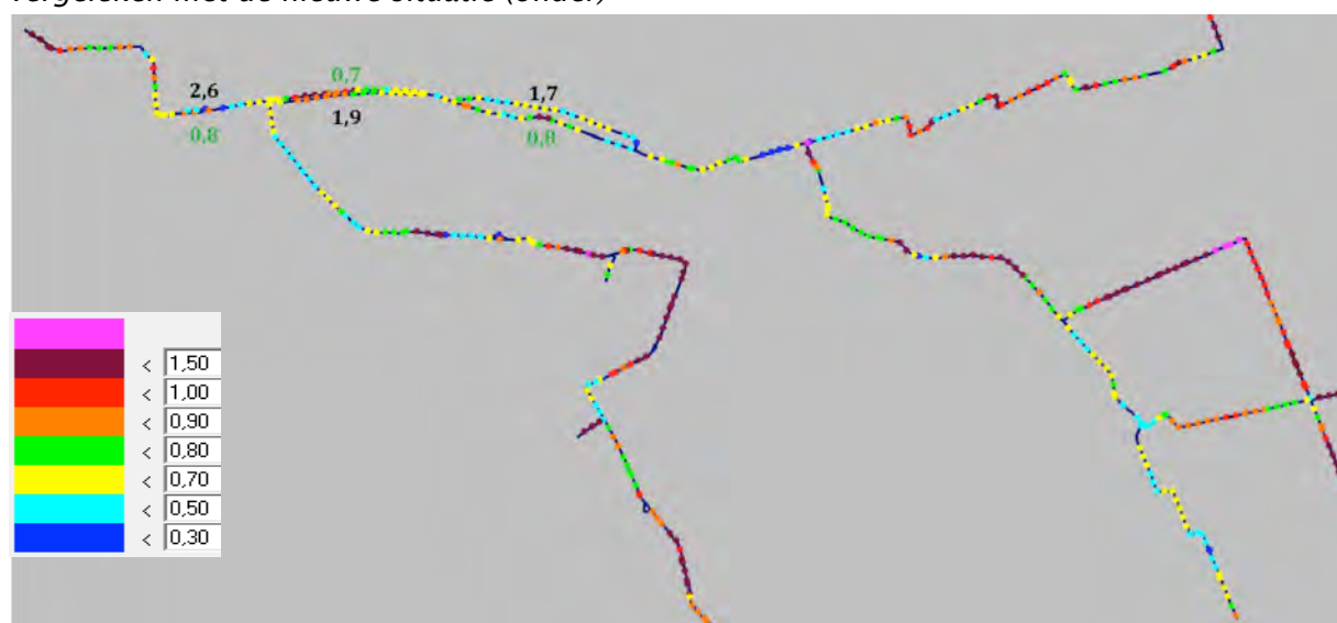
Figuur C.9: Stroomsnelheid [m/s] bij extreme omstandigheden in de huidige situatie (boven) vergeleken met de nieuwe situatie (onder)
