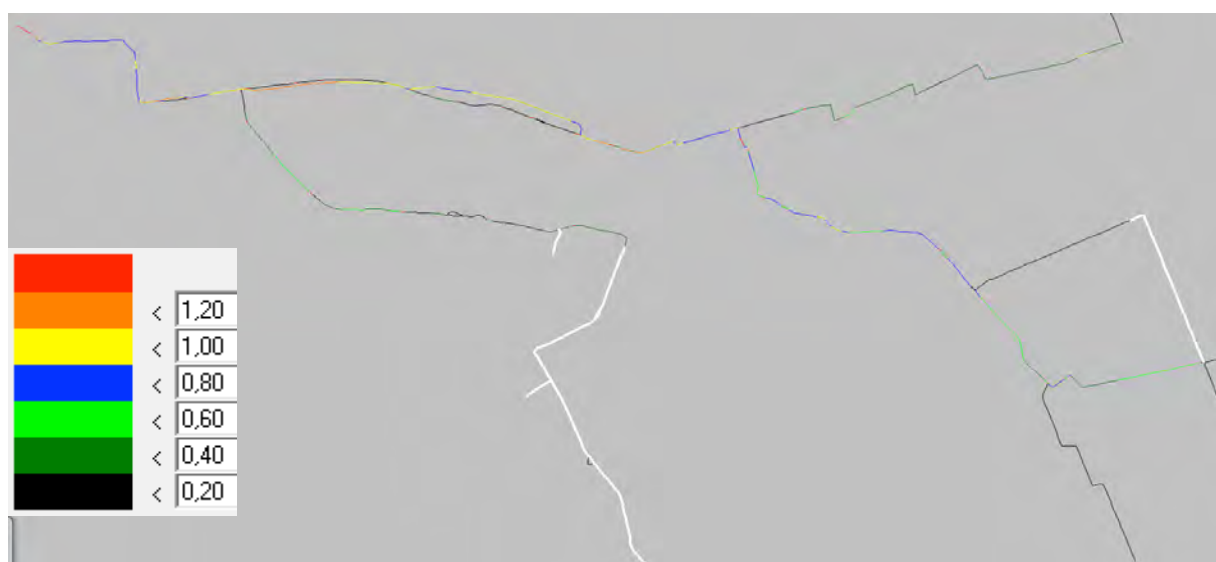
Figuur C.9: Stroomsnelheid [m/s] bij extreme omstandigheden in de huidige situatie (boven) vergeleken met de nieuwe situatie (onder)
