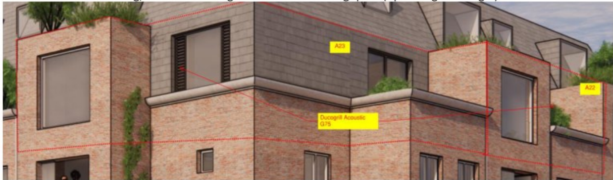
Figuur 7: Toepassing van Duco Acoustic grill voor woning A22 en A23
