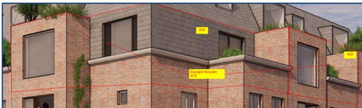
Afbeelding 15: Toepassing van Duco Acoustic grill voor woning A22 en A23
