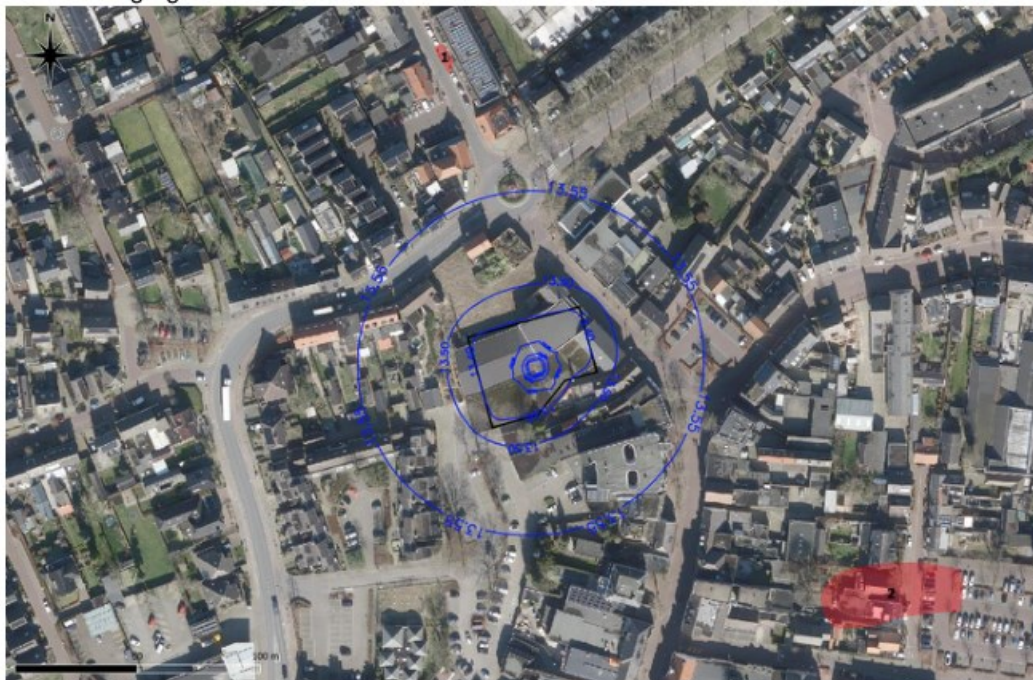
Figuur 8: Invloedsgebied bemaling ten opzicht van nabijgelegen grondwaterverontreinigingen.
