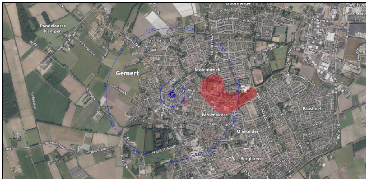
Figuur 6: Invloedsgebied bemaling ten tijde van een GHG. Schematische contouren van grondwaterverontreinigingen in rood (bron Inpijn-Blokpoel)
