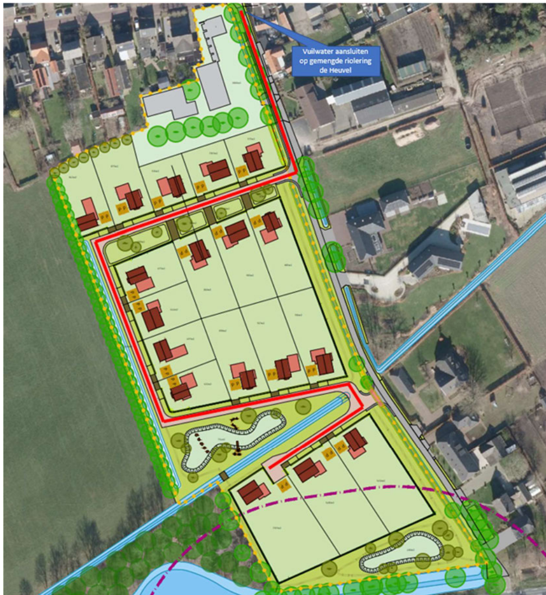
Afbeelding 26 Principe ontwerp vuilwater systeem (rode lijn) met aansluiting op Heuvel
