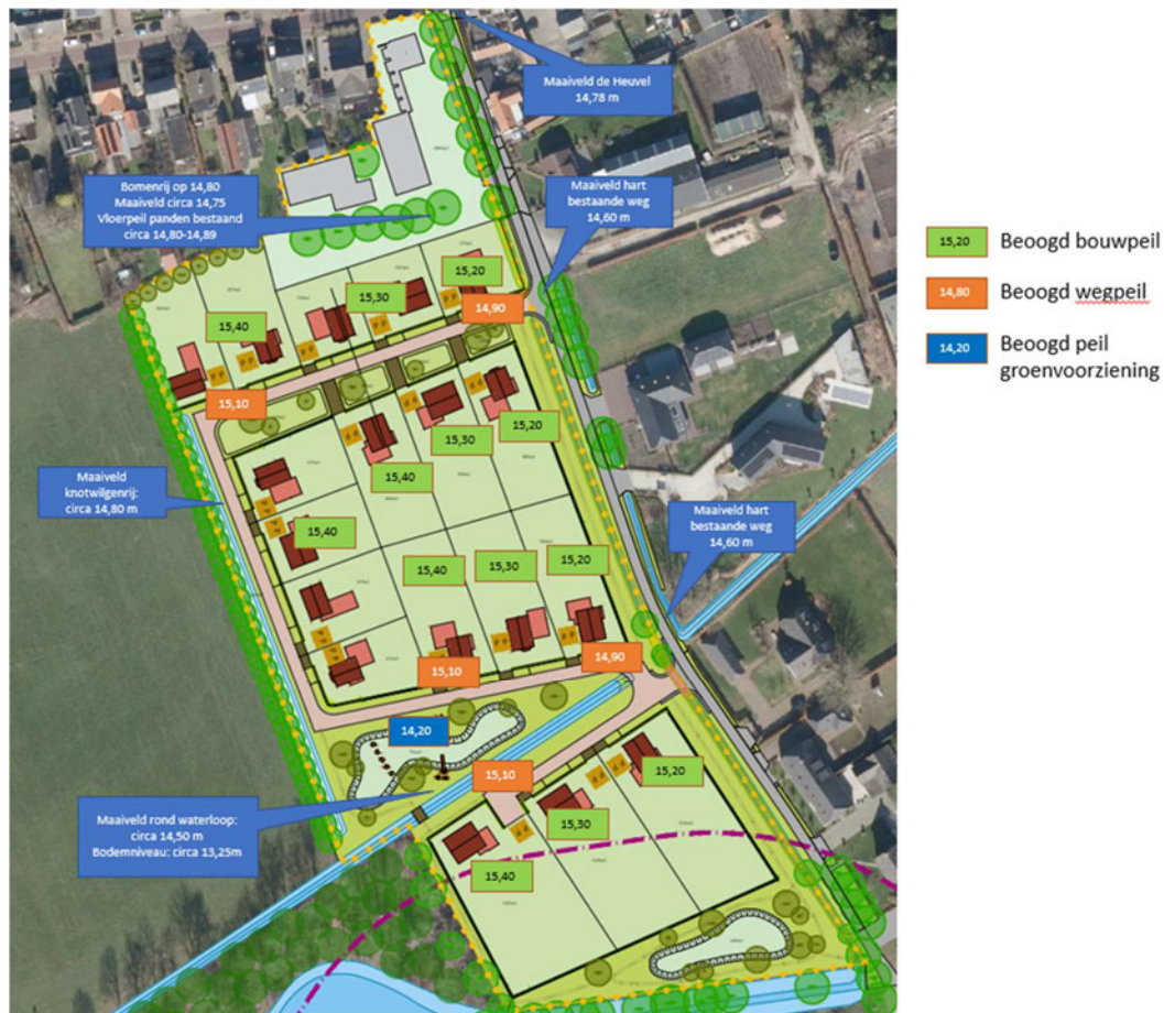
Afbeelding 22 Voorstel bouwpeilen en wegpeilen
