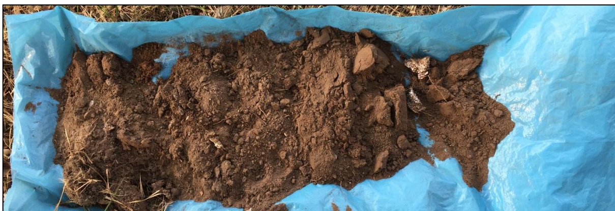
Boring 6: 0-70 cm -Mv. Meermaals gestaakt in laag puin met piepschuim, te zien op 70 cm -Mv.
