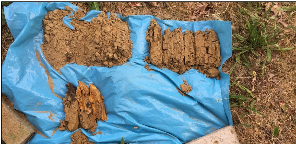
Boring 10: 0-130 cm -Mv. Deze boring wijkt in zijn geheel af wegens de aanwezigheid van een pakket ophoogzand tot een diepte van 105 cm -Mv.
