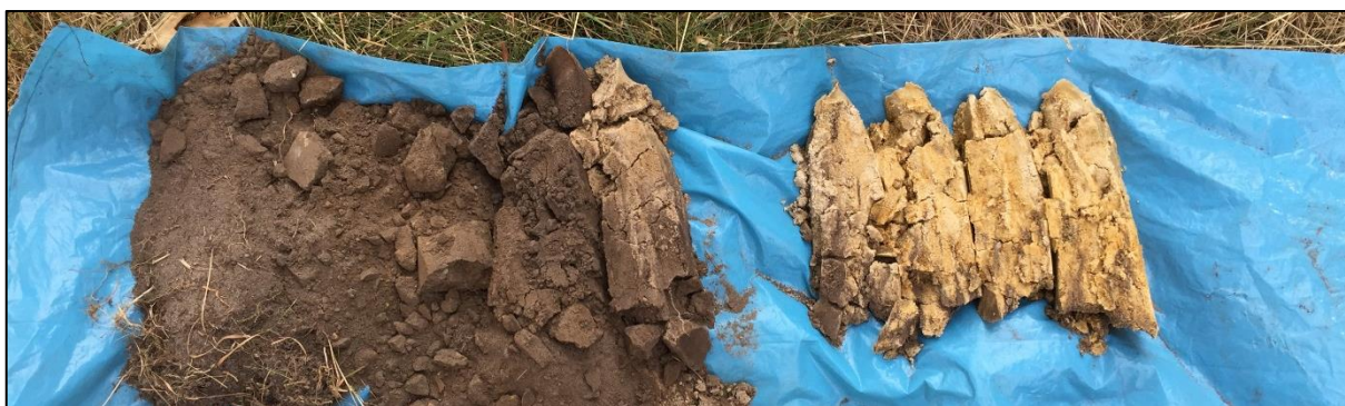
Boring 8: 0-90 cm -Mv. Potentiële akkerlaag op een diepte van 45-55 cm -Mv.
