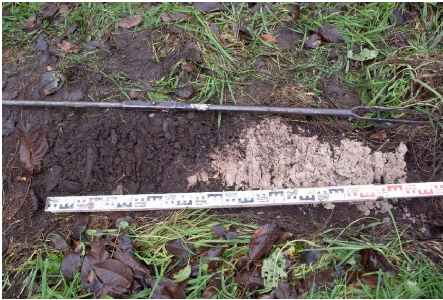
foto 6 Overgang op circa 70 cm beneden het maaiveld
