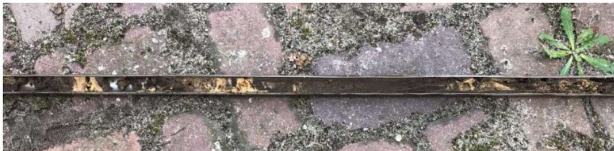
Figuur 21: Foto van het enigszins moerige zandpakket met brokken geel zand dat op alle boorpunten onder het pakket vergraven zand is aangetroffen.
