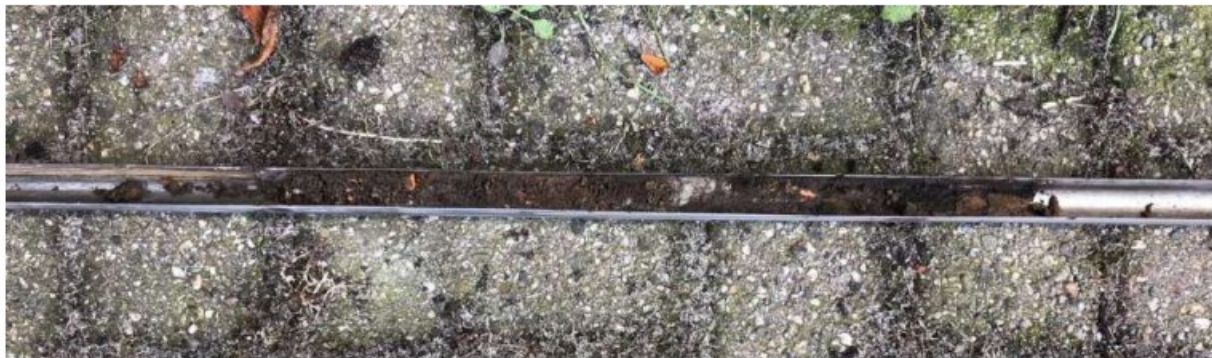
Figuur 22: Foto van het enigszins moerige zandpakket met brokken cement en rood baksteen zoals aangetroffen in boring 7.
